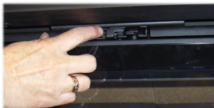
Изображение 4: Открытие запорного механизма дверцы
